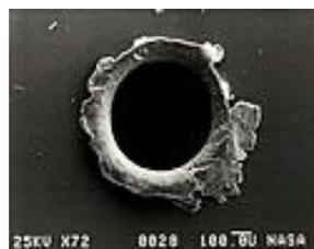
NASAの太陽観測衛星の外壁のスペースデブリ衝突痕拡大写真
