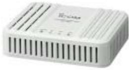
ISDN 回線を収容するためのゲートウェイ装置です。
