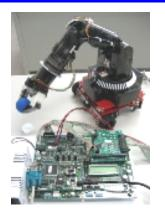
稼働します。これらのセンサー情報及び DC モータ を μlTRON 組み込み学習キットから、マルチタスク処理で、リアルタイムに制御できるように製作されています。
