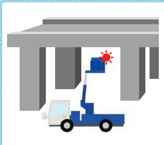
▲ 高所作業車の衝突防止対策
