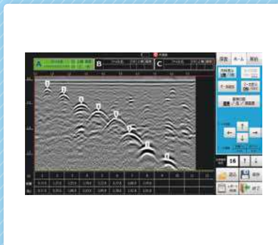
▲埋設管の反射波を自動検出し、 判定を容易にします。
