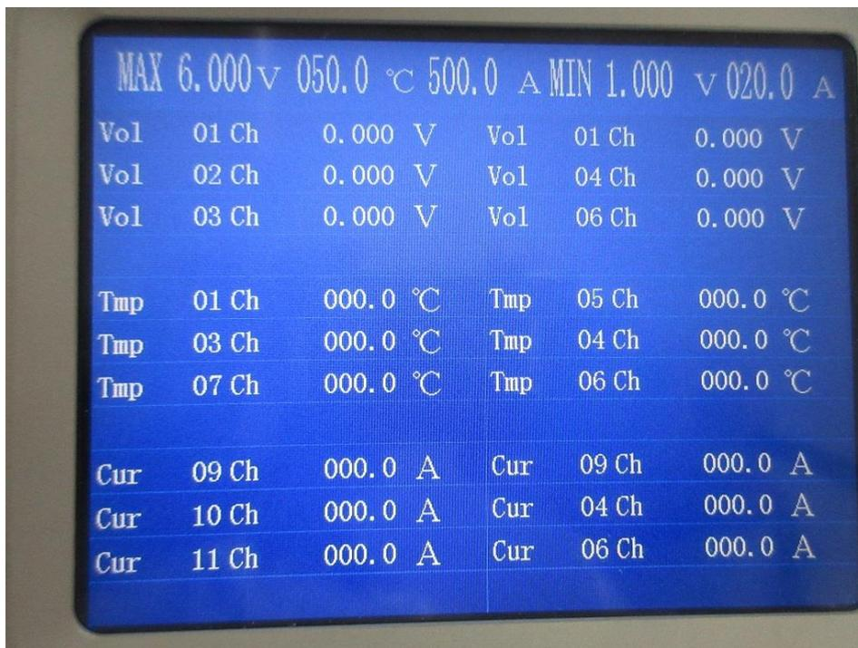
⑤電圧、温度、電流センサが設定された上下限值を超過した時、超過したチャンネルが赤表示となり、リレーが作動します。
